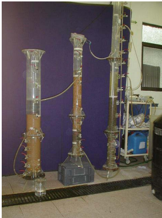
Figura 3. Sistema de filtración en múltiples etapas modificada (FIMEM).
